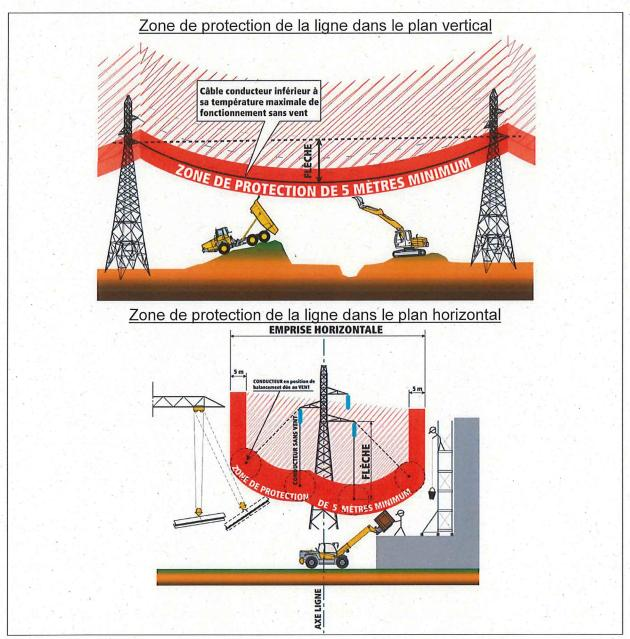
ZONE DE PROTECTION à observer pour l'exécution de travaux au voisinage d'une ligne aérienne électrique dont la tension est supérieure à 50000 Volts.
